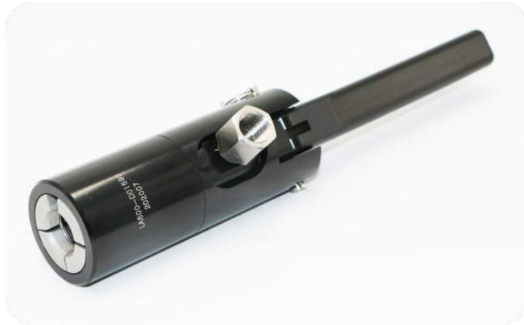
Der Schnelladapter LA800 ermöglicht eine schnelle und einfache Dichtheitsprüfung von geraden Rohren; der Anschluss ist für Unterwasser-, Druckabfall- und Vakuumprüfungen mit Helium geeignet. Der LA800 verfügt über eine eingebaute Sicherheitsvorrichtung, die verhindert, dass er sich unter Druck plötzlich löst. Die interne Dichtungsstruktur sorgt für Langlebigkeit und hohe Dichtheitsprüfleistung.
