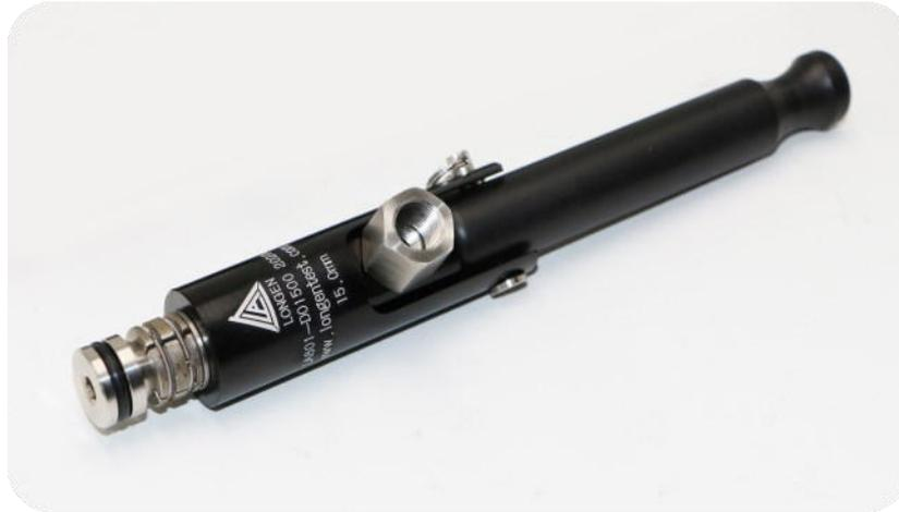
Der Schnelladapter LA801 eignet sich für Unterwasser-, Druckabfall- und Heliumprüfungen von geraden Rohren und Bohrungen (Innendurchmesser). Der Anschluss ist mit einem Sicherheitssystem ausgestattet, das verhindert, dass der LA801 versehentlich getrennt wird, während er unter Druck steht. Das radiale Dichtungssystem arbeitet zuverlässig und effektiv.
