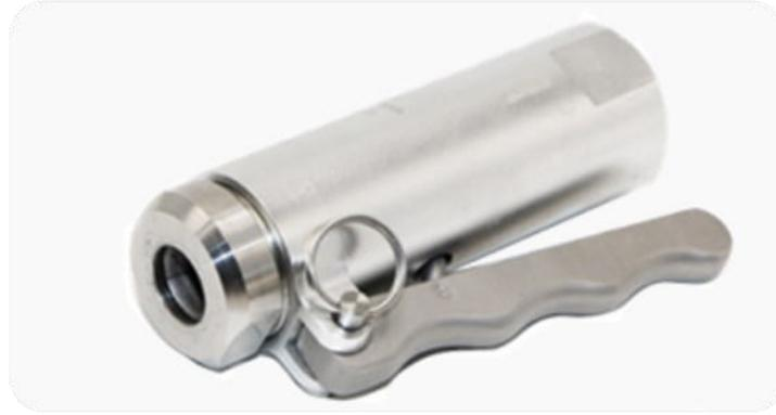
Der Schnelladapter LA802 bietet druckdichte Verbindungen an geraden Schläuchen und hat sich durch seine einfache Handhabung bewährt. Der LA802 ist ein hebelbetätigter Adapter, der beim Verbinden und Trennen keine Seitenkräfte erzeugt, die den Prüfling oder den Füllanschluss verformen können. Der LA802 ist mit einer internen Sicherheitsfunktion ausgestattet, die das Abziehen des Anschlusses verhindert, bis ein Druck von weniger als 5 bar erreicht ist.
